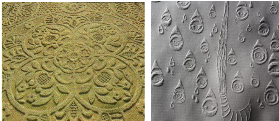
Dos sustratos textiles con gofrado: no tejido (izquierda) y tejido de calada (derecha)
